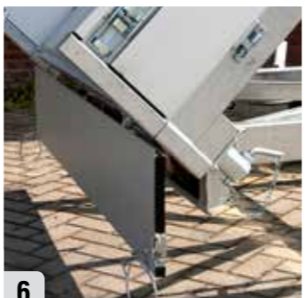
6 Riddle arrière: en position inclinée toujours suffisamment de distance au sol, en constituant en même temps une protection efficace des feux arrières
