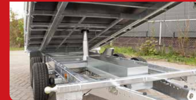
Batterie et pompe hydrolique dans caisse protectrice au chassis
