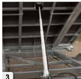
3 Vérin très puissant (5 cylindres) inclinaison 48° (force de traction 6100 kg)
