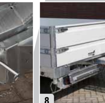
8 Chassis surbaissé avec rangement de rampes (en alu ou acier) (option)
