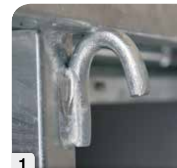
1 Crochets d'arrimage solides tout autour en série!
