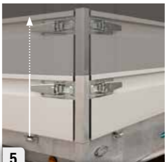
5 Fermetures de ridelles intégrées (série) Ridelles ALU (30 cm) supplémentaires et amovibles (option)
