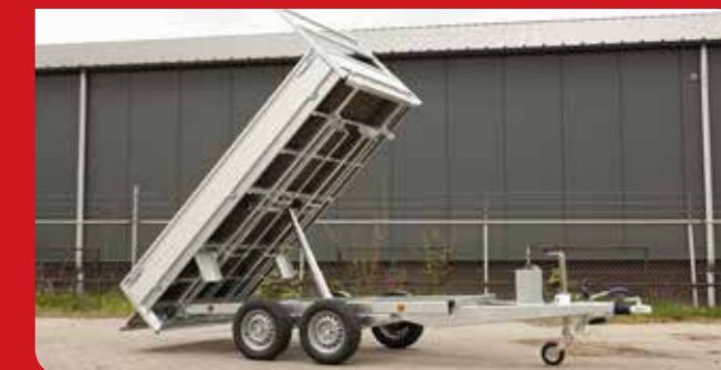
Vérin très puissant (5 cylindres) inclinaison 48° (force de traction 6100 kg)
