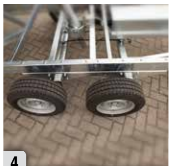
4 Train d'essieux avec supports longues (meilleure répartition de forces)(série)
