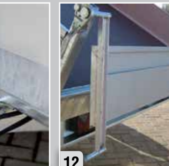
12 Riddle arrière articulant en haut et en bas (option)
